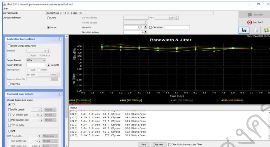
ภาพที่ 105 ผลทดสอบ Switch Cisco Satid --> Server ที่มา : ภาพผลการเก็บข้อมูลด้วยโปรแกรม J-Perf วันที่ 19 สิงหาคม 2560
