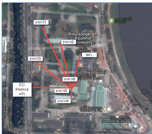
ภาพที่ 36 การเชื่อมต่อระบบเครือข่ายส่วนวังจันทน์อาคารต่างๆ
