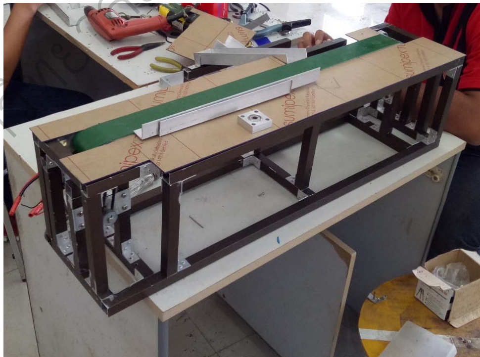
รูปที่ ข-11 แสดงภาพการวางโครงสร้างรางเก็บวัสดุด้านบน
