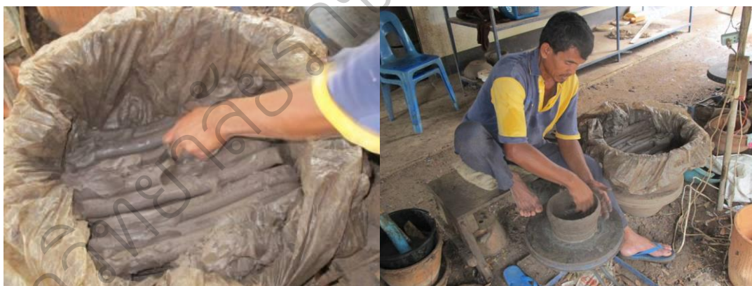
ภาพที่ 2.13 การแสดงลักษณะการคลึงดินเป็นเส้นก่อนที่จะขึ้นรูปโถ่งของช่างในชุมชนเครื่องปั้นดินเผา หมู่บ้านเชียงเครือ จังหวัดสกลนคร
