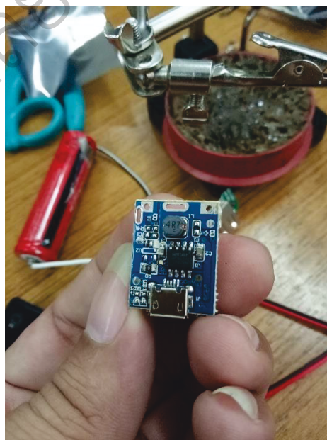
รูปที่ ข-9 แสดงภาพอุปกรณ์ชุดบอร์ดเตอร์สำรองของ Node MCU Server
