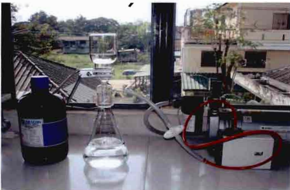
ภาพ 11 ชุดกรองเมมเบรนเส้นผ่าศูนย์กลาง ขนาด 13 มิลลิเมตร และ 47 มิลลิเมตร พร้อมแผ่นกรองชนิด ไนลอน ขนาด 0.5 ไมโครเมตร
