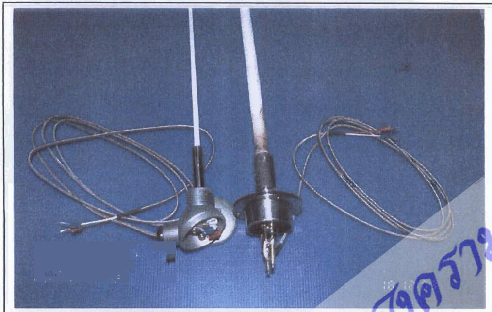
ภาพประกอบ 12 แสดง Thermocouple มาตรฐานและ Thermocouple ที่ประดิษฐ์ขึ้นมา
